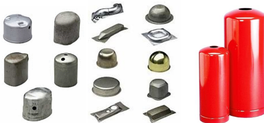
Рис. 1.5 – Типовые детали, полученные глубокой вытяжкой (с отбортовкой)
