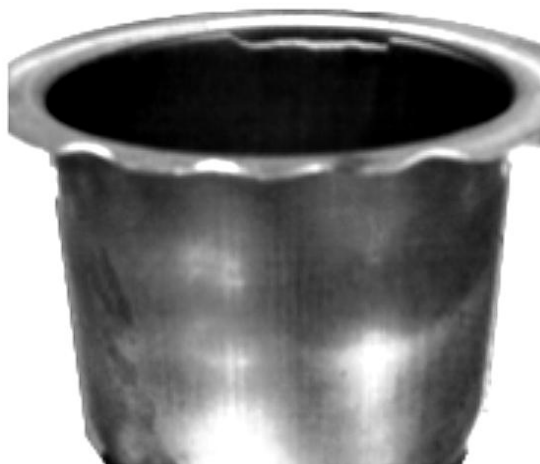
Рис. 2.3 – Стакан диаметром 110мм, высотой 92 мм из стали 08Ю с кольцевой трещиной
