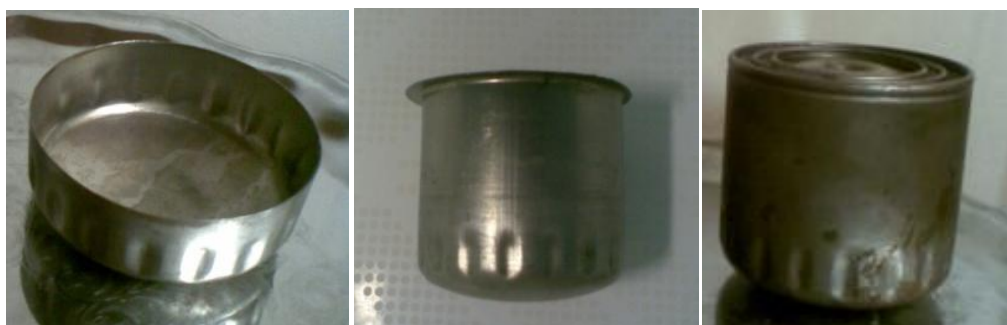
Рис. 4.4 – Схема потери устойчивости и образования складок при вытяжке из гладкой заготовки
